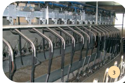
Salle de traite 2x16 places avec ligne haute.
