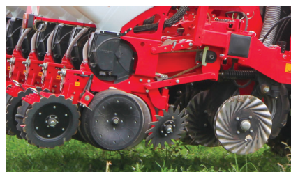
Semoir mono-graine équipé pour le semis direct de maïs.
