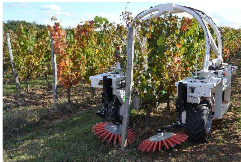
Robot de désherbage mécanique Ted – Naïo Technologies
