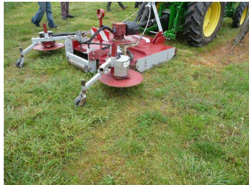
Tondeuse combinée inter-rang et satellites intercepts AVIF 33
