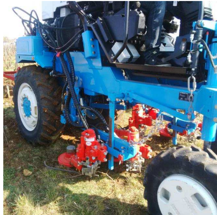
Interceps hydrauliques Boisselet sur tracteur enjambeur Bobard
